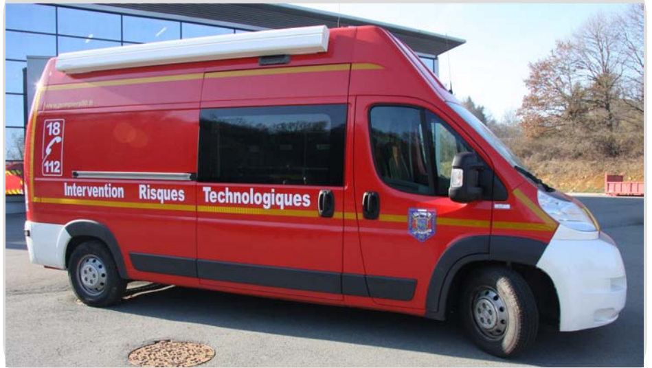
Châssis de type LH3. Motorisation de 120 CV et un PTAC de 3,5 T
